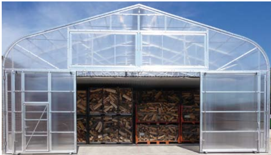
L'entrée du séchoir solaire et son chargement de bois à sécher
